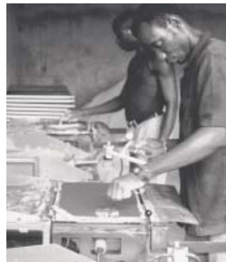
*Moldeando una teja sobre el vibrador.*
