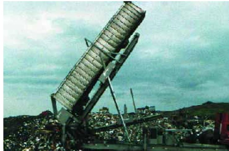
Otro sistema, dentro de los denominados motorizados, son los vehículos de transporte y contenedores utilizados conjuntamente con instalaciones para la compactación de residuos. En este caso, la compactadora estacionaria compacta los residuos contra la placa interna del remolque. Cuando la presión de la placa alcanza un valor determinado, el diafragma se mueve hacia dentro permitiendo que se compacten más residuos en el remolque.
