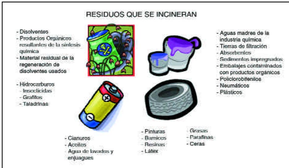
**Figura 9.22: Esquema de Residuos con probabilidad de incineración.**
