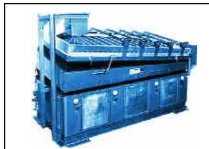
**Figura 9.3. Sistema de separación por gravedad.**
