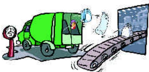
Los camiones se pesan y a continuación descargan su contenido en la nave de recepción. Los residuos acceden al interior de la planta mediante cintas de alimentación.
