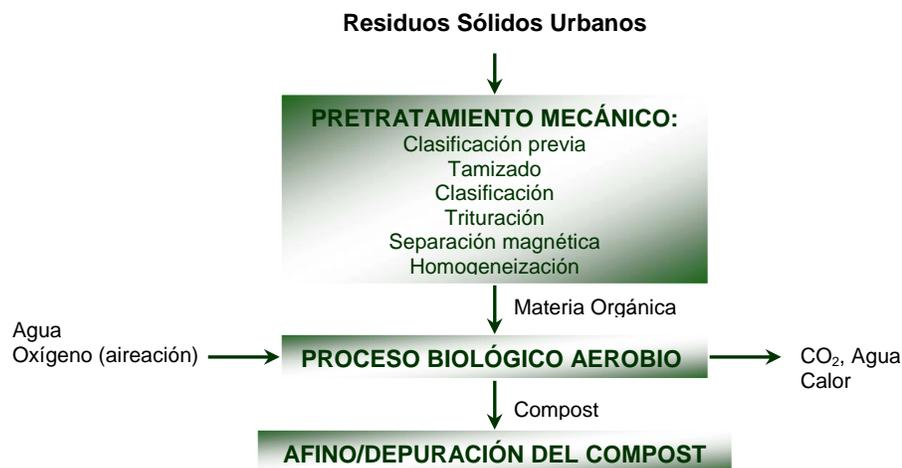
Figura 7. Esquema del proceso de compostaje [16].
