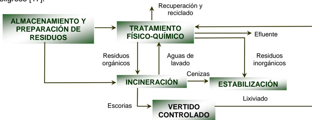
*Figura 13. Esquema de una instalación de tratamiento de Residuos Peligrosos [17].*
