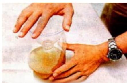
Colocar la parte superior de la botella invertida dentro de la base (a modo de embudo). Puede ser necesario sellar los bordes
